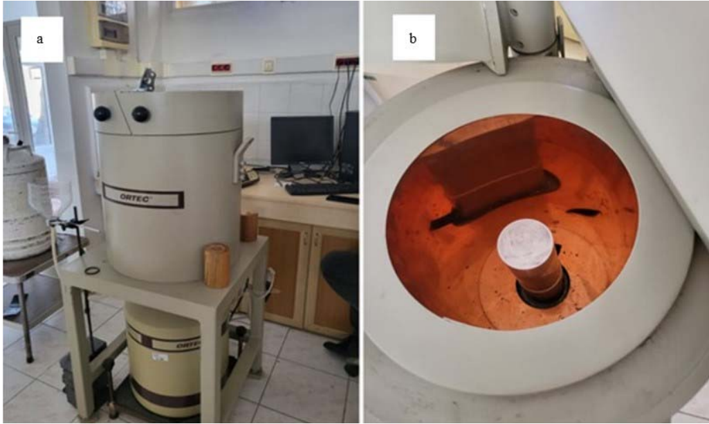
Şekil 4. Nötron kaynağı sayım sistemi ve gama spektrometresinin a) dıştan, b) üstten görünüşü (Neutron source counting system and gamma spectrometer from the a) outside, b) top view)
